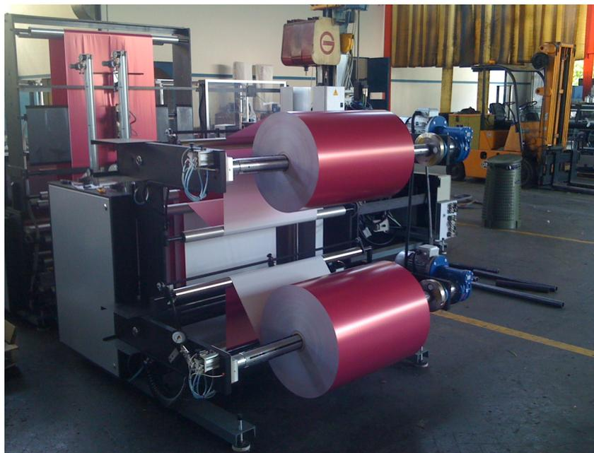
**■** *Svolgitore doppio motorizzato con controllo automatico indipendente della tensione del film di ogni bobina al variare del diametro e della velocità di svolgimento . L'unità è completa di:*
